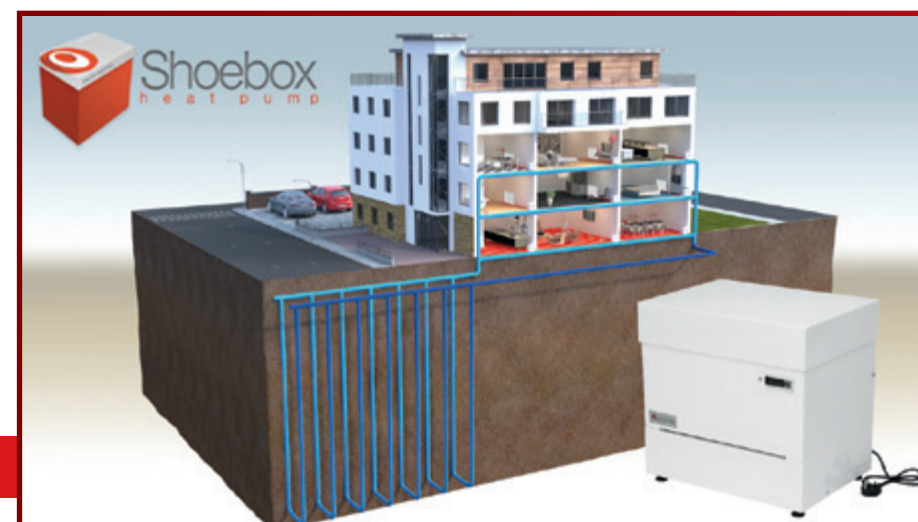
Appartementencomplex met collectief Tichelman bronsysteem
